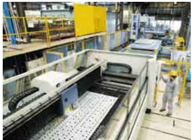
図 CO レーザーによる自動素材切断システム
