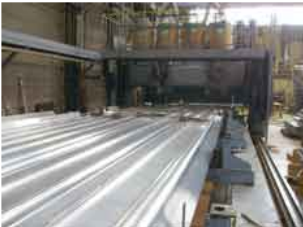
図5 アルミ台枠とタンデムミグ溶接機
