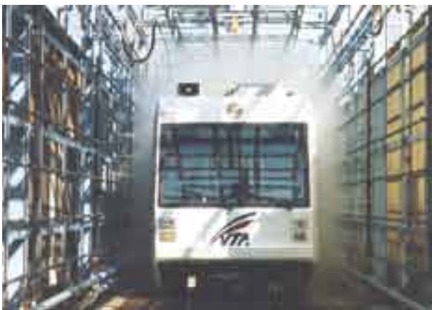
図 4 構体および車体水密検査
