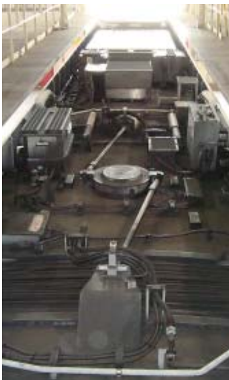
車体屋上のZリンク機構(NJT向けLRV)
