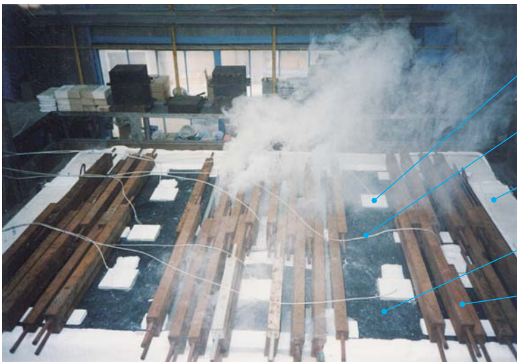
図1 加熱炉上での床構造燃焼試験
