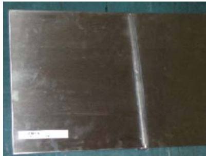
図6 溶接サンプルA(ルートギャップ2mm)
