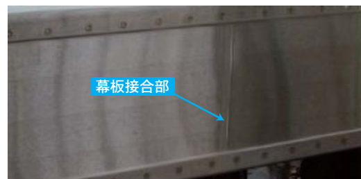
図10 完成構体幕板接合部
