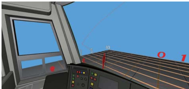
図2 3Dによる前方視界の検討図 フェニックスLRV
