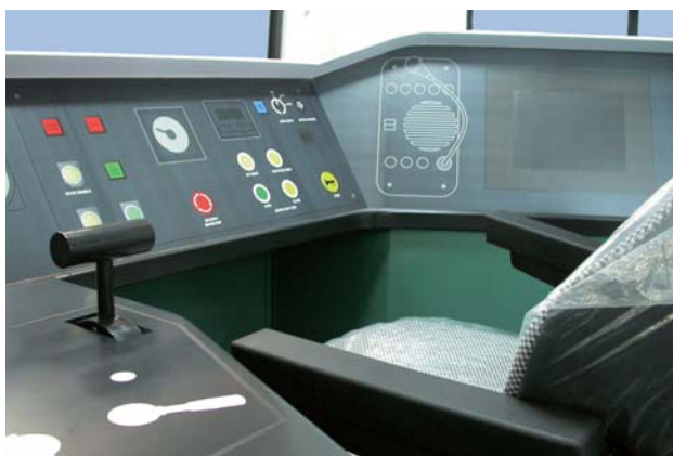
図3 マニラ向け電車の運転台（モックアップ） 前方視界を確保しつつ、一体化したコンソールにモニタを収めた
