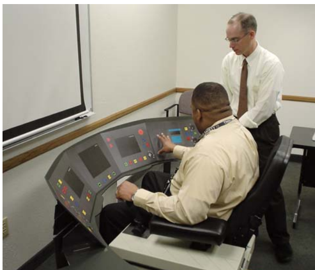
図6 フェニックスLRVの運転台(モックアップ) マスコンを回転式いすに一体化することで限られた空間を有効に活用
