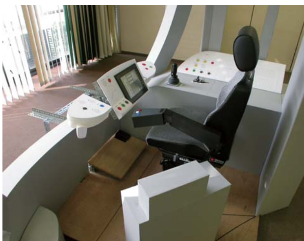
図5 広島電鉄グリーンムーバーmaxの運転台(モックアップ) 車いすが通れる通路を確保しつつ空間効率を向上
